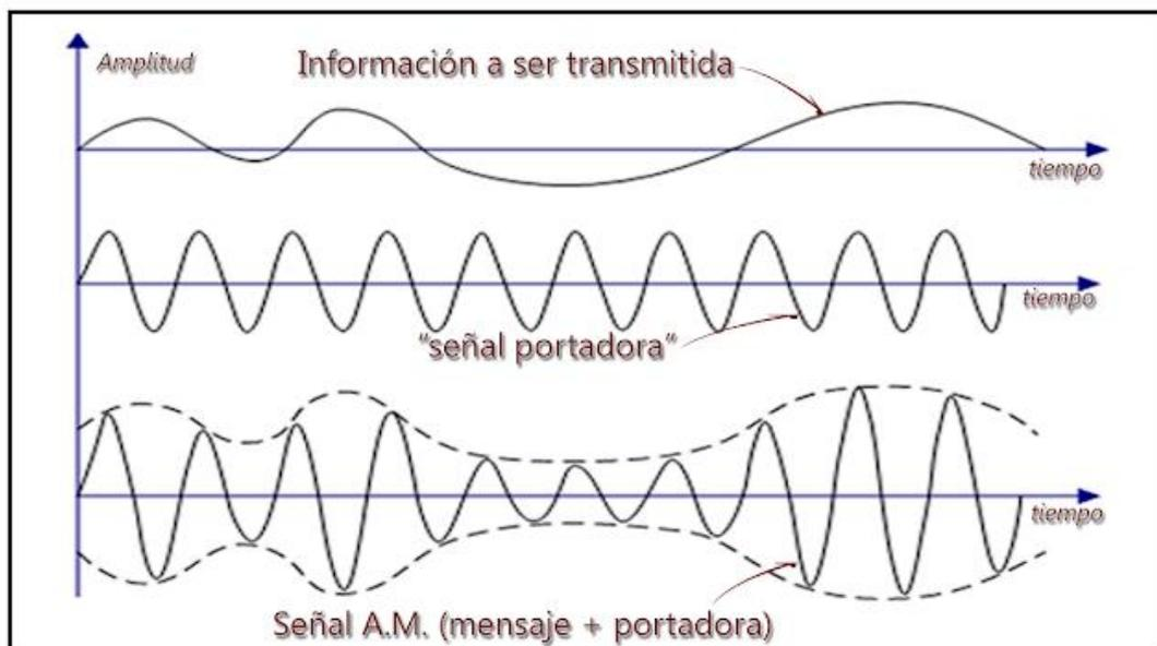
Fig.4- Amplitud modulada significa amplitud (de la onda portadora) “moldeada” por el mensaje a transmitir
